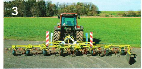
作業状態への操作は、最初にローターが外側へ広げられ、次に牽引の車台が折りたたみされます。
