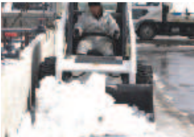
すくう、運ぶ、積込むと使い勝手の良い 除雪用大容量バケット
