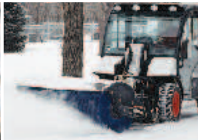
路面の雪を高速回転ブラシで掃き飛ばす アングルブルーム
