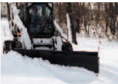
寄せて集める除雪、傾きは油圧制御 スノーブレード
