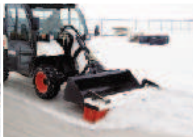
バケット下部にブラシをボルト装着 ウイскарブルーム
