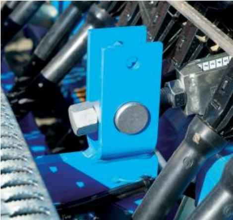
ダブルディスクコルターの種子深度は、シードドリルの中央にあるネジで連続的に調整できます。頑丈なコルターフレームを回すと、ダブルディスクコルターに対するプレッシャーローラーの位置が変わり、種子の深さが変わります。
