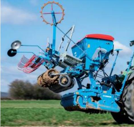
オプションのセミマウントコンセプトのおかげで、**Saphir**は油圧シリンダーを介して前方に移動することで持ち上げが容易に。これにより、フロントアクスルの負荷が軽減されます。さらに油圧シリンダーに、ハイドロクリップを使用してコルターバーに対する基本フレームの位置を個別に調整できます。
