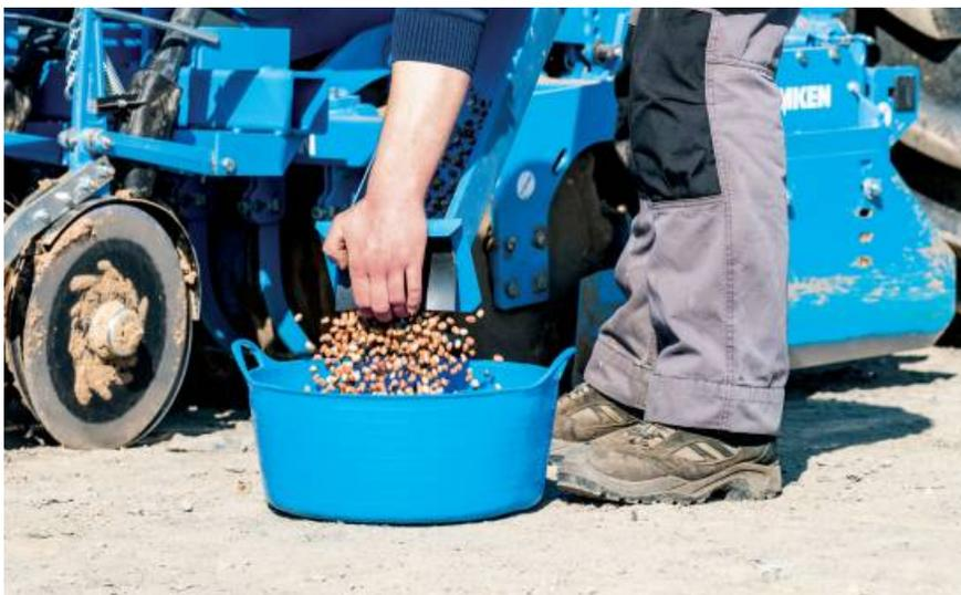
種子は、2つのキャリブレーショントレーに集まるようになっているため、キャリブレーションテストは迅速かつ簡単に行えます。
