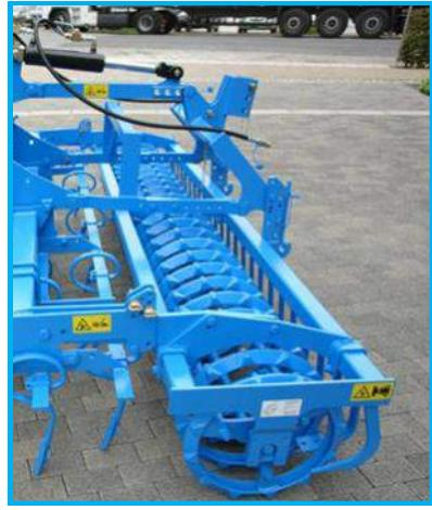
フロントに装着したクオーツは、フロントファロープレスの代用として使用することができます。後に続く播種床準備の作業のために、トラクターの前で整地・碎土・鎮圧を行い、パワーハロー／カルチベーターと組み合わせたシードドリルで播種を行います。そのため作業回数の減少や、土壤保護に役立つため時間やコストが節約できます。
