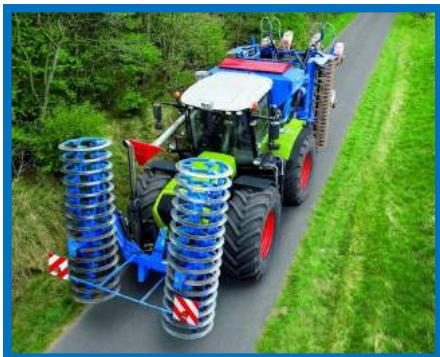
バリオパックの鎮圧作業は、トラクターによる地面の沈み込みと、その後に作成されるトラクターホイール間の土の隆起を防ぐ役割を果たします。
