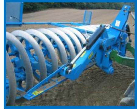
機械式のステアリングシステムは、作業境界を正確にマッチさせるため、カーブをさせながら作業を行うことができます。
